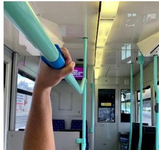
Innerhalb wenigen Wochen haben die Fachleute von K-Profile den Clip-On-Tube zusammen mit dem Endkunden entwickelt. Dabei nutzt K-Profile die im Betrieb vorhandenen 3D Drucker für erste Prototypen. Die Konstruktion der Profile und Extrusionswerkzeug erfolgt mittels CAD, sodass die Werkzeuge in kürzester Zeit im eigenen Werkzeugbau hergestellt werden.
